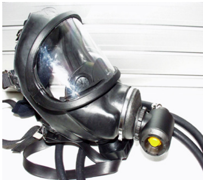
11. ábra Auer mentőegység (Normál nyomású tüdőautomata (sárga nyomógomb), álarc, középnyomású tömlő gyorscsatlakozóval)
