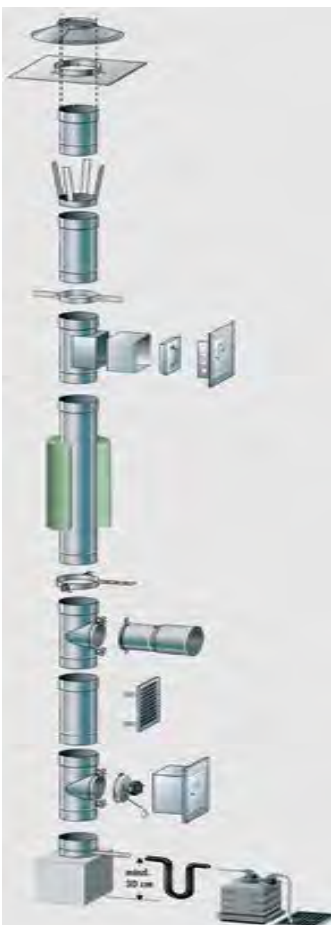
Merev és hajlítható utólagos fém bélésűvezetések
