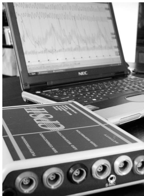
3. kép Stoelting típusú nyolccsatornás számítógépes poligráf rendszer (CPS II)
